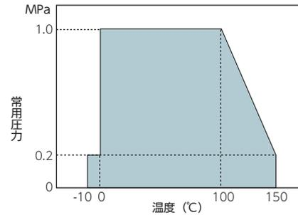
※高耐食性流体の場合は、最高許容圧力・温度が低くなります。
